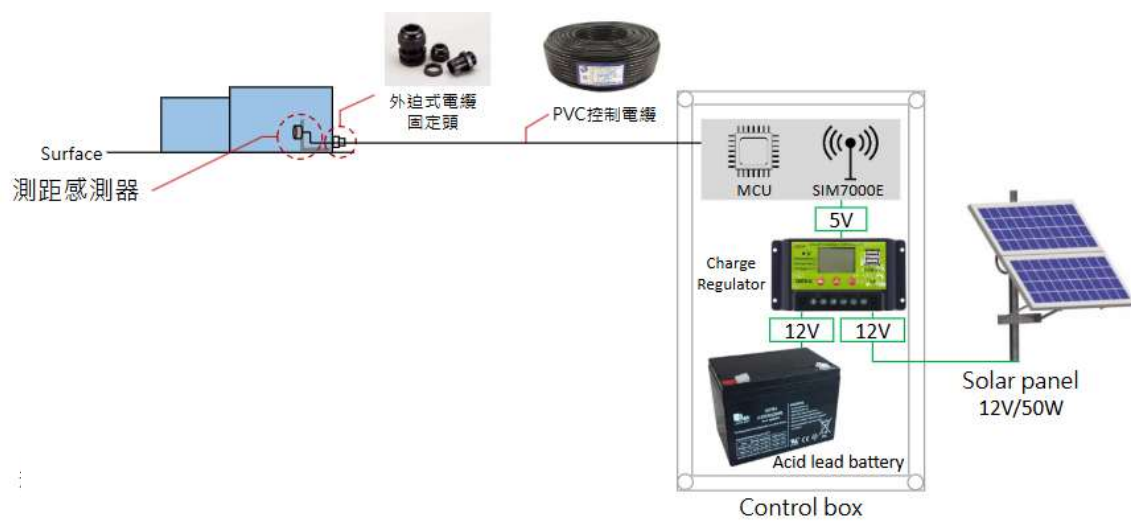
圖-7 裂縫儀模組集成示意
