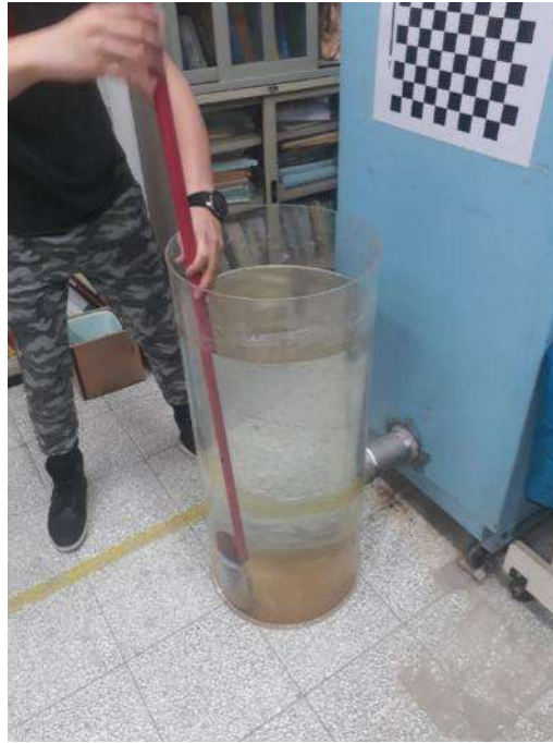
圖-20 防水 IP 試驗
