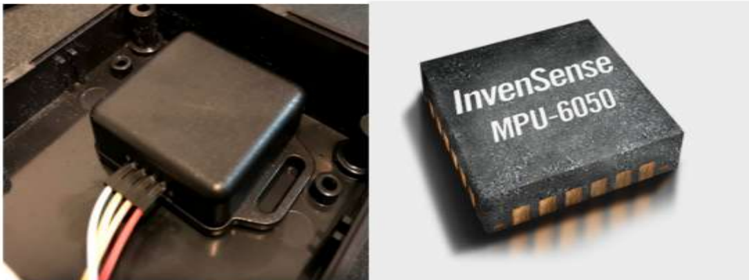
圖-9 坡面運動監測儀核心晶片 MPU-6050
