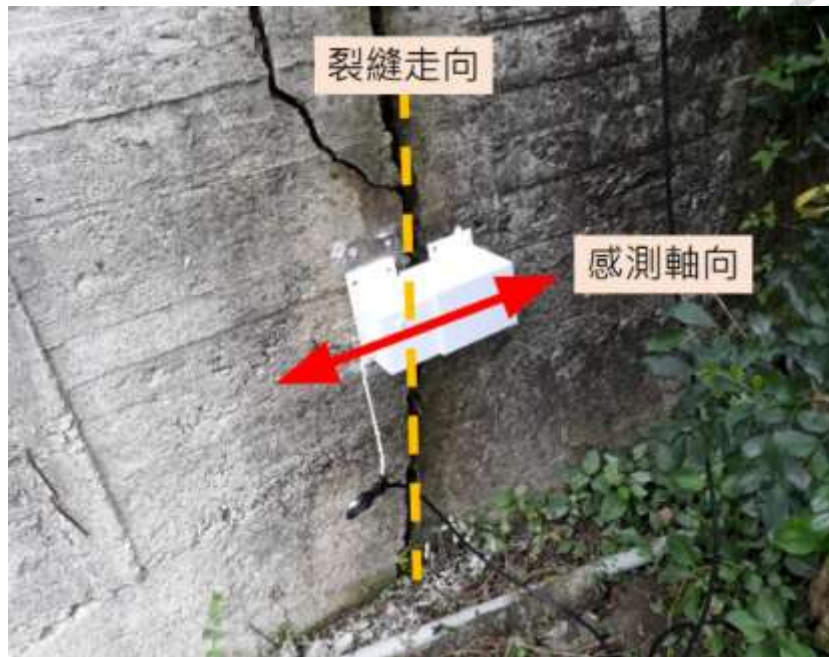
圖- 39 裂縫計安裝方式[27]
