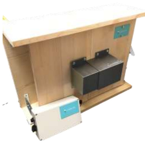
圖-4 裂縫儀模組測試件集成外觀
