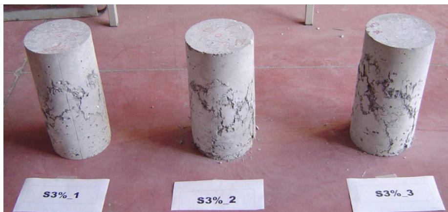
圖 2-7 V_f = 3\% 之高強度鋼纖維混凝土圓柱破壞情形[2]
