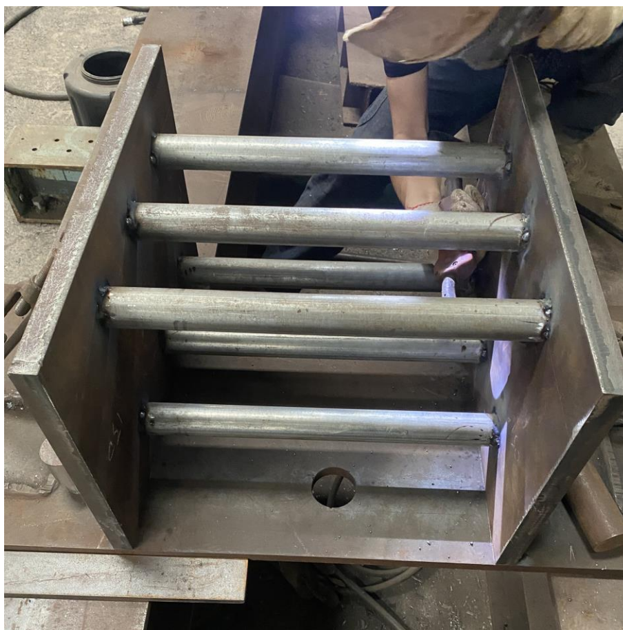
圖 3-2 預埋鋼套管和上下鋼版
