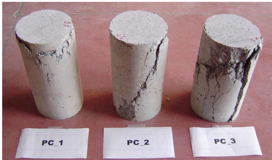
圖 2-6 高強度混凝土圓柱破壞情形[2]
