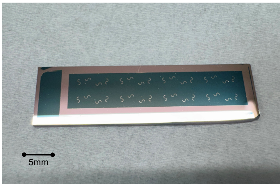
圖 4-15 圖案化的單晶矽應變規結構實際影像
