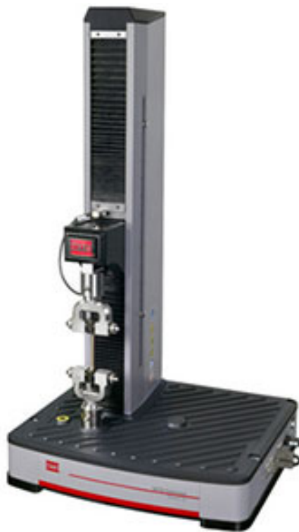
圖 2 - 24 萬能材料試驗機- C42.503
