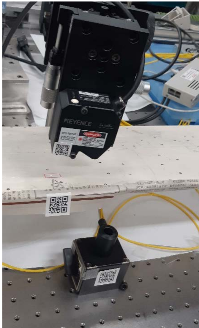
圖 4 - 3 風機葉片振動位移量測實驗量測點近照
