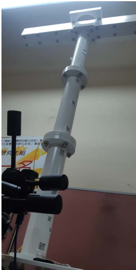
圖 4 - 39 橫梁振動量測實驗架設
