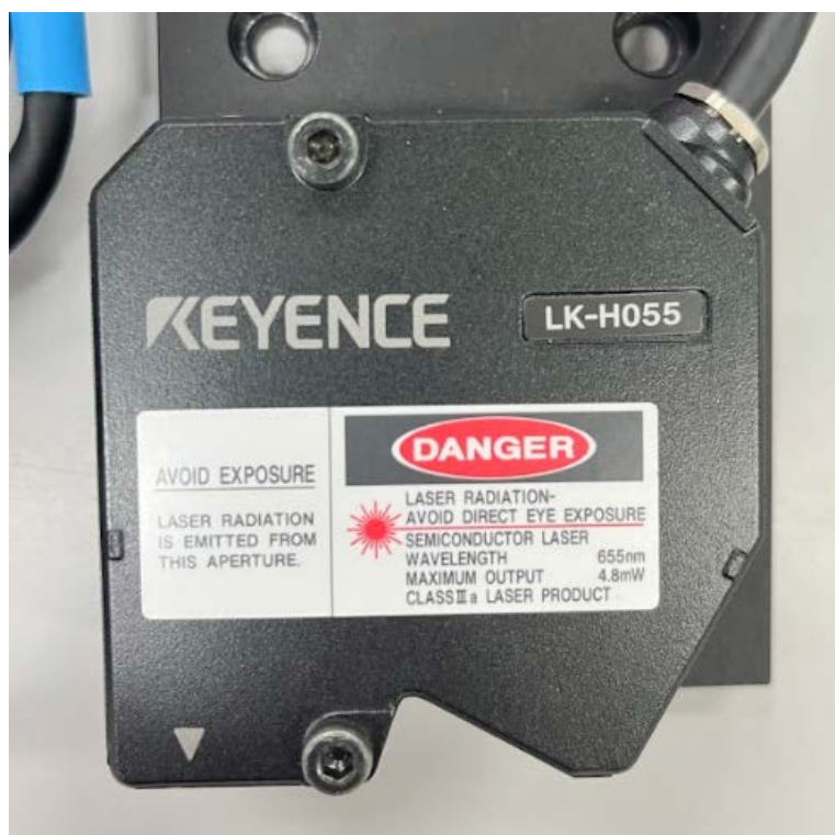
圖 2 - 20 雷射位移計- LK-H055 外觀圖
