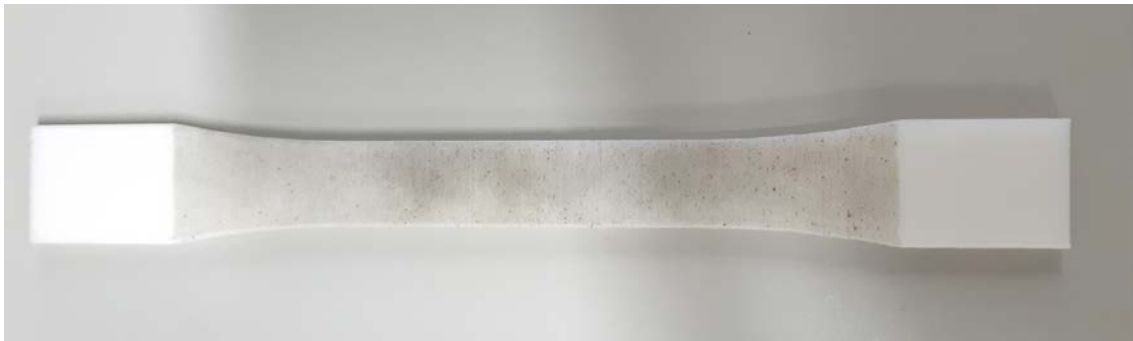
圖 3 - 55 3D 列印拉伸試片實體圖
