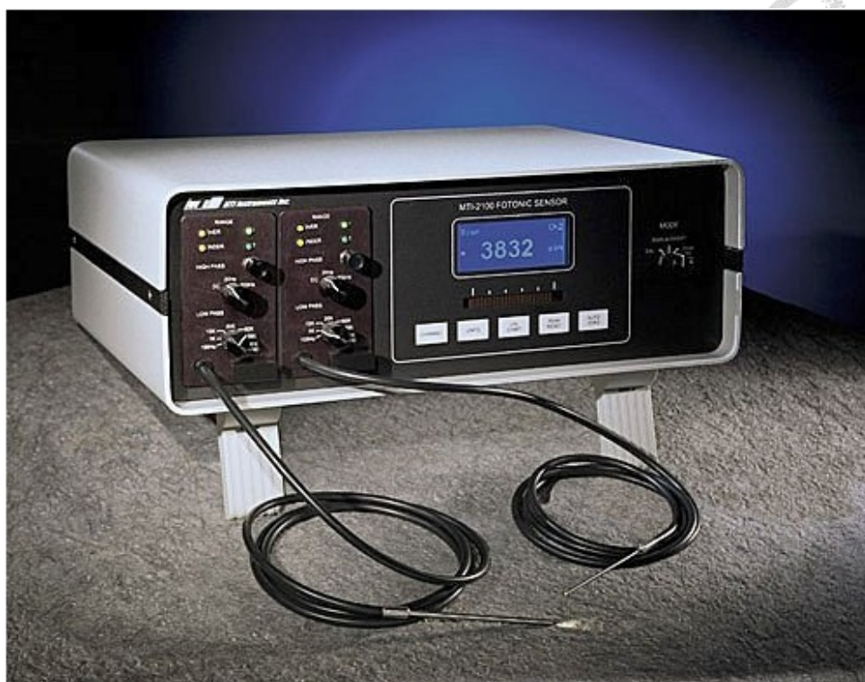
圖 2 - 21 光纖位移計- MTI-200 外觀圖
