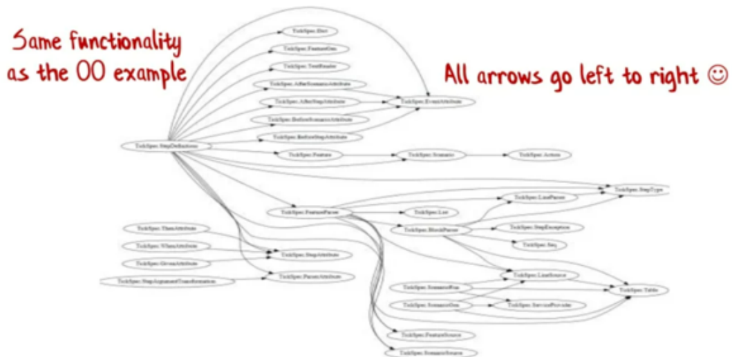
圖 6.3: (a) 物件導向式 (Object-oriented programming, OOP)，強調相關功能由類別打包設計 (b) 管線導向式 (Pipeline-oriented programming, POP)，強調功能由管線化依序設計 (Wlaschin, 2014)。本研究從物件導向式 (OOP) 部分重構成管線導向式 (POP)，能解決程式碼在未來挑整時，牽一髮動全身的問題。
