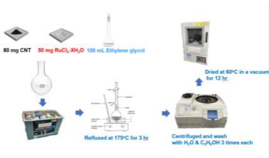
圖 2-2 鈦金屬修飾之奈米碳管合成實驗步驟示意圖。
