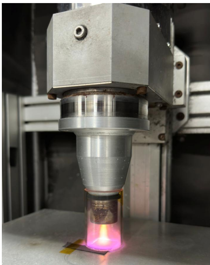
圖 3.2-3 本研究使用之常壓噴射電漿系統示意圖
