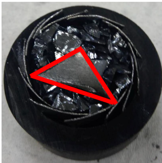
圖 2-18、GES 研究中啟弧配置改良。紅色三角形為加在矽顆粒上方的石墨紙。
