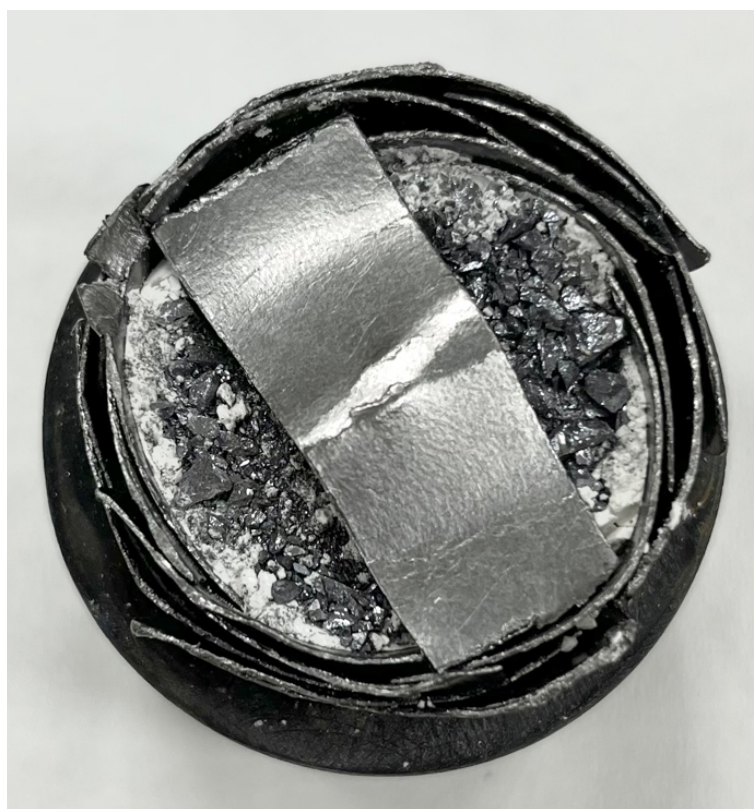
圖 4-6、前人研究之啟弧配置圖，在原料上放置石墨橋使電弧得以啟動。
