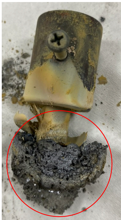
圖 4-12、所有固態原料啟弧後快速固化成碳化矽(紅圈部分)。
