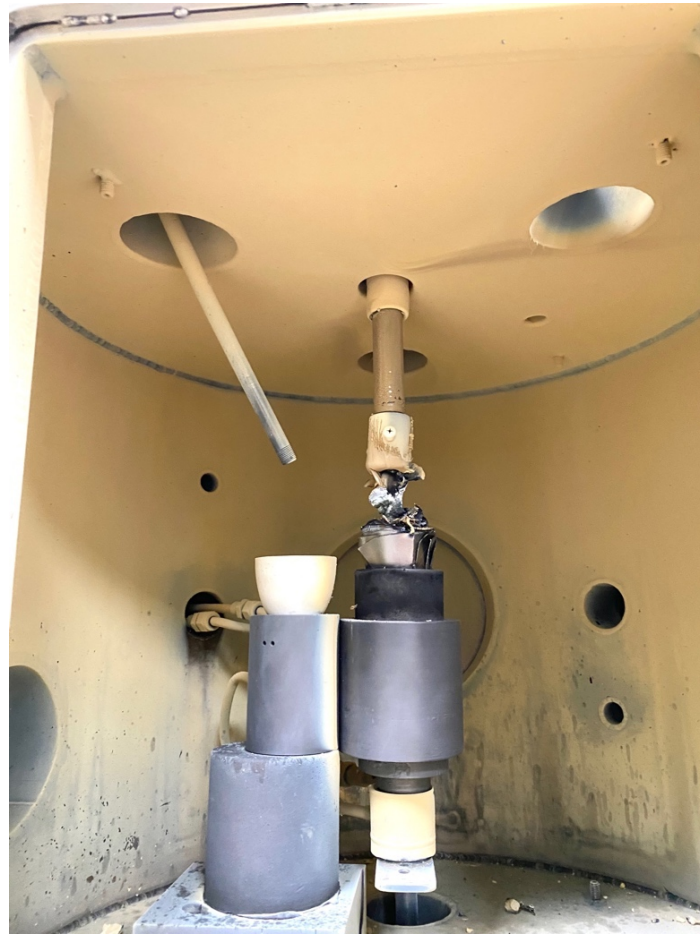
圖 4-23、配置編號 2 並同時使用固態與液態碳源實驗後，真空艙內照片。
