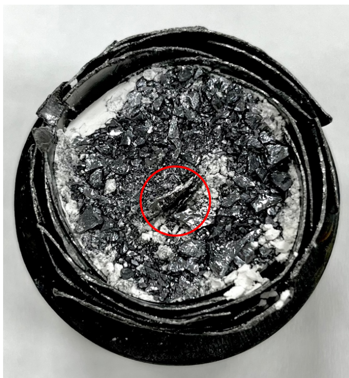
圖 4-9、坩堝內增加導電柱後，將原料放入坩堝之實體圖。紅色圓圈為導電柱，其必須高過原料並接觸真空艙的陰極，以完成接觸啟弧。
