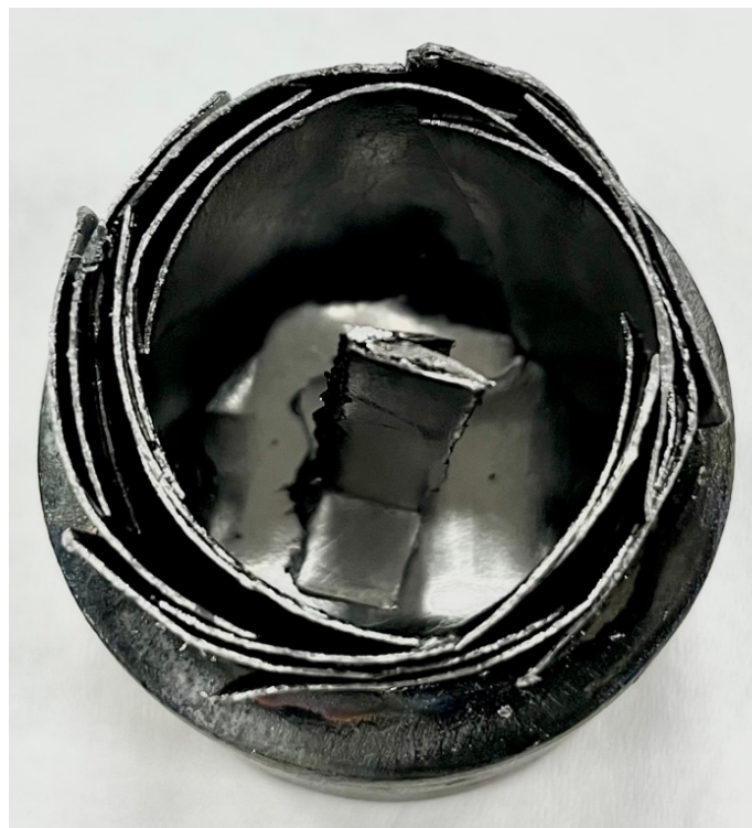
圖 4-8、在坩堝底部中央黏上一石墨紙摺成導電柱之實體圖。
