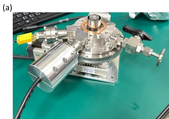
圖 3.2-2(a)同步輻射中心(NSRRC)的加熱載台；(b)Al-15Cu 與氧化鋁套筒
