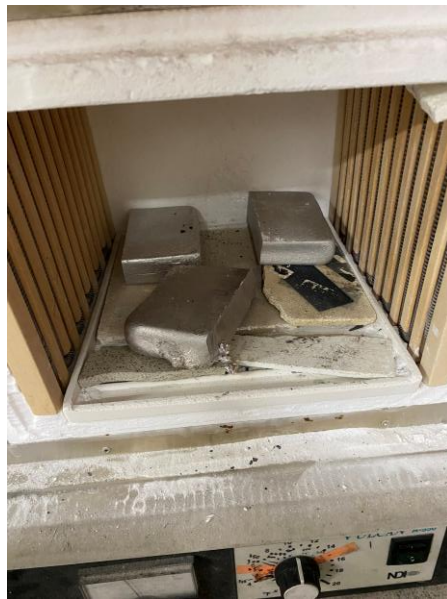
圖 3.2-1 在球化前的試片以及中溫爐
