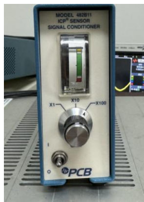
圖 3- 17 PCB 48211 感測器訊號調節
