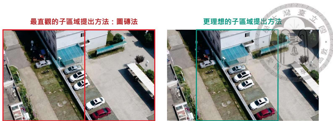
圖 2.1、圖磚法與理想的子區域提出方法間的差異。左圖圖磚法提出的子區域的邊界劃分在目標物上，也需較多的子區域來涵蓋全部的目標物。右圖為較為理想的子區域提出方法，一個子區域包含多個完整的目標物。
