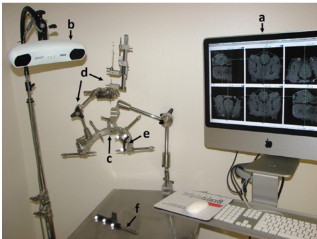
圖十九、獸醫之光學神經導航系統組件。系統包含：導航軟體與電腦（a）、雙攝影機（b）、頭部固定器（c）、附量尺與針具的關節臂（d）、參考架（e），以及導航探針（f）。(1)
