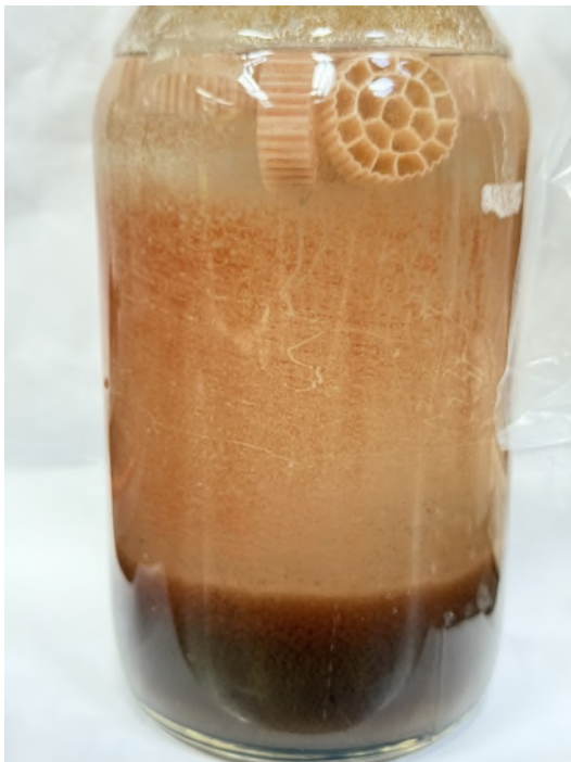
圖 4.8、AC1 至 AC4 反應槽中塑膠載體 ANAMMOX 菌群附著與瓶壁紅色生物膜形成情形(a) AC1；(b) AC2；(c) AC3；(d) AC4
