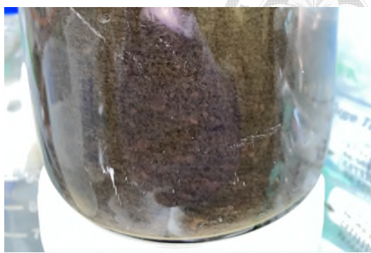
圖 4.1、(a)ANAMMOX 系統中污泥發黑跡象；(b)更換含硝酸氮機質後之污泥狀況
