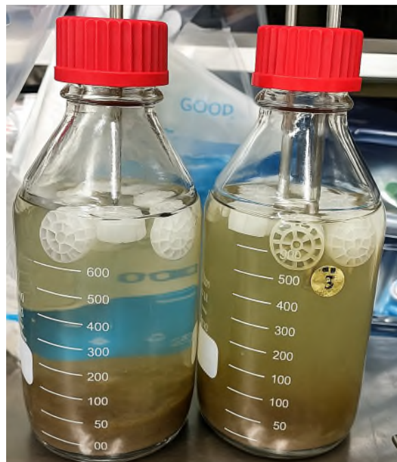
圖 3.3、食品廠廢水處理廠活性污泥植種後初期照片
