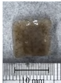
圖 4.30、根據網格設計列印之 PVA-PEGDA/ Light 載體
