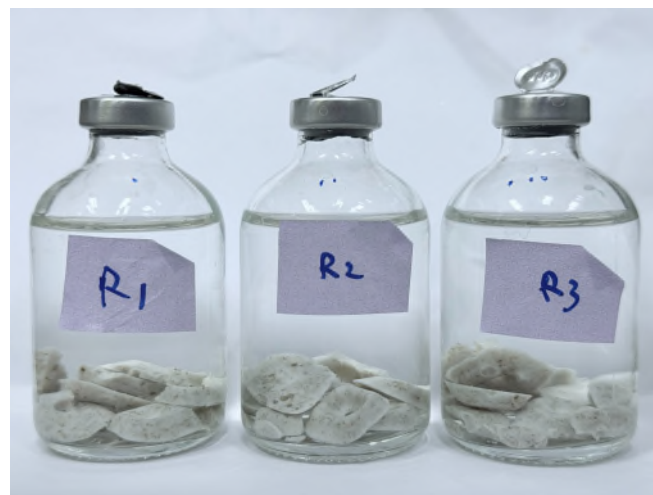
圖 4.35、ANAMMOX 固定化載體批次反應瓶測試狀態(a) PVA-SA-PEGDA/ Ca-Light 載體；(b) PVA-PEGDA/ Light 載體
