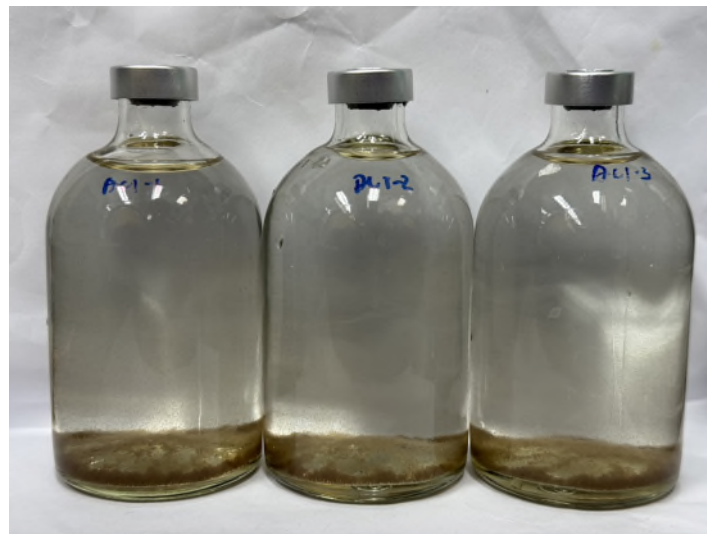
圖 4.23、AC1 懸浮態 ANAMMOX 菌群於比活性(SAA)測試中之反應瓶狀態
