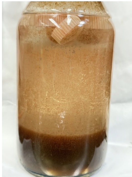
圖 4.8、AC1 至 AC4 反應槽中塑膠載體 ANAMMOX 菌群附著與瓶壁紅色生物膜形成情形(a) AC1；(b) AC2；(c) AC3；(d) AC4
