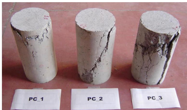
圖 2-8 高強度混凝土圓柱破壞情形[5]
