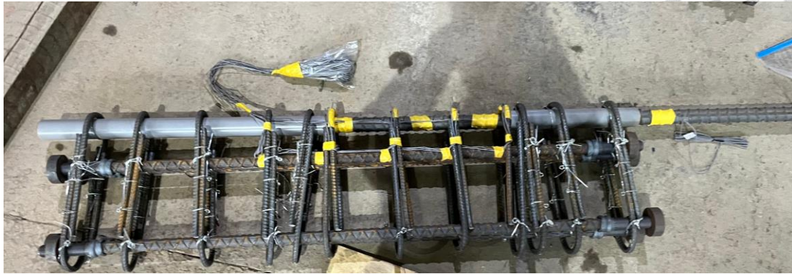
圖 3-10 應變計粘貼作業之示意圖
