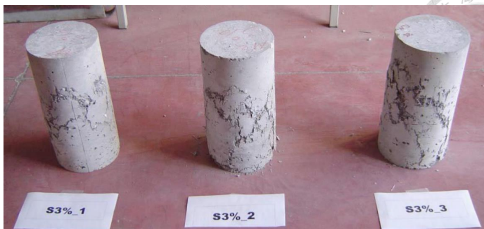
圖 2-9 高強度鋼纖維混凝土圓柱破壞情形[5]
