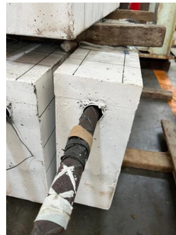
圖 5-3 試體 F49S75D 握裹拉拔破壞情形
