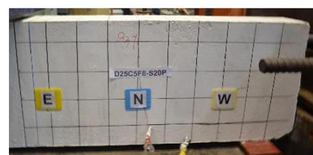
(b) 試體北面之破壞情形
