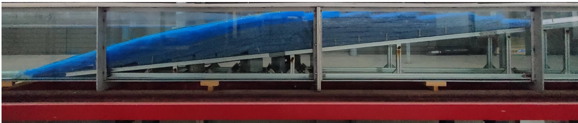
圖 1.4: 被動式消波-藤棉緩坡板部分實景
