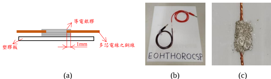
圖 5.32 導電銀膠試片 (a)製作示意圖 (b)實際整體圖 (c)實際局部圖
