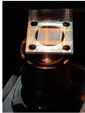
附圖 47 將表面貼有霧面質感之隱形膠帶的蓋玻片放置於列印平台方形槽中並將 CIS 放置於列印平台圓孔下方
