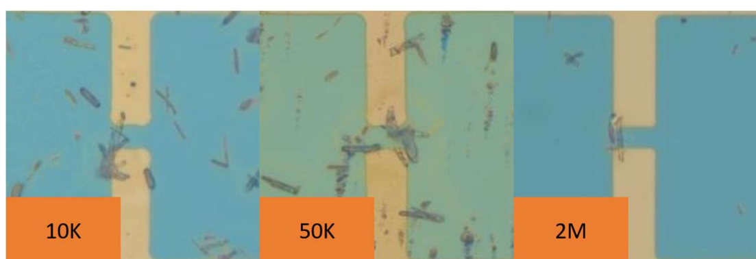
圖 3-7 在電壓 7V_{pp} 下不同頻率之定位效果
