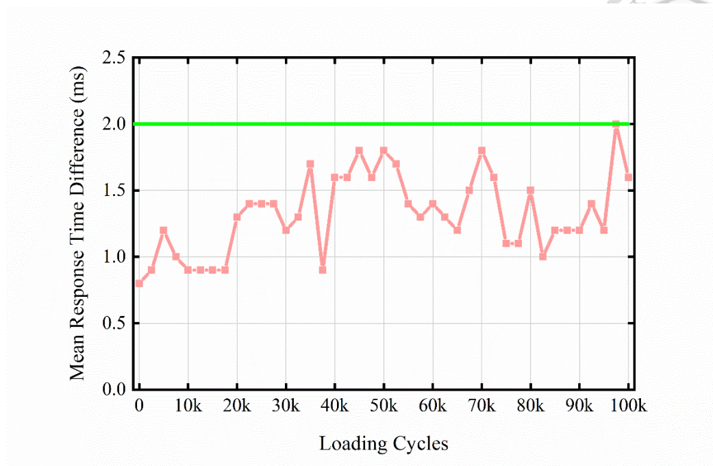
圖 3-24 以厚度 0.3 mm 矽膠片預壓平均響應時間差隨下壓次數之變化
