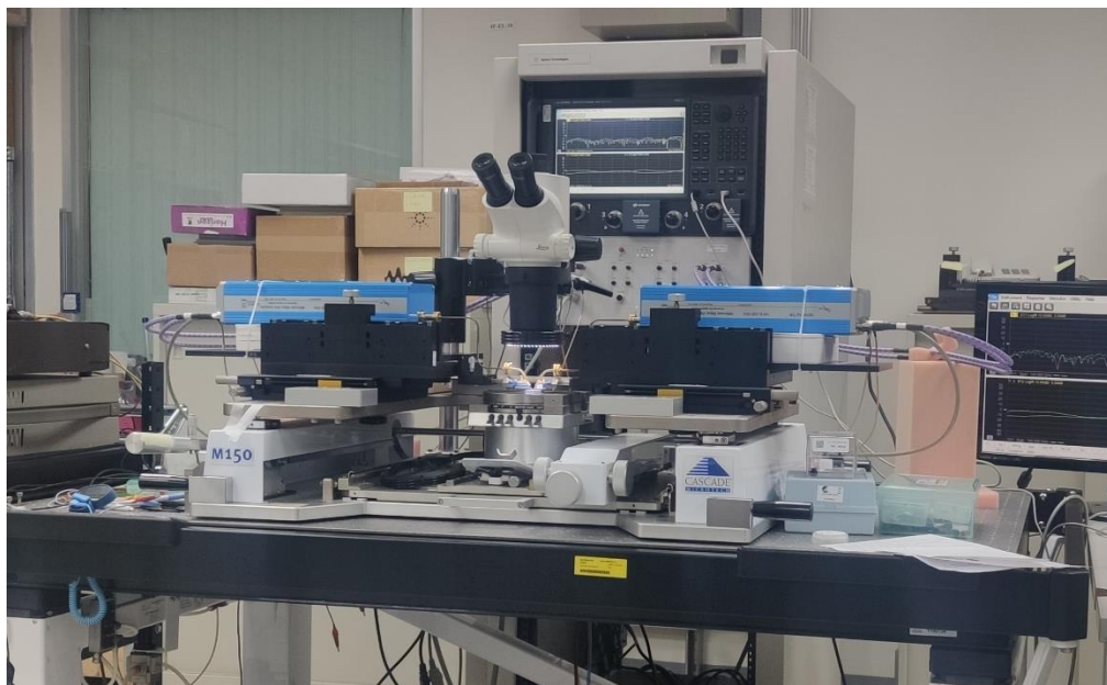
圖 2.51 S 參數之量測架設
