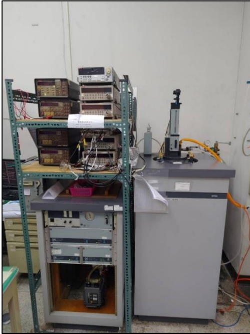
圖 3.7 超導量子干涉儀 (a) 型號 MPMS2 (b) MPMS3。
