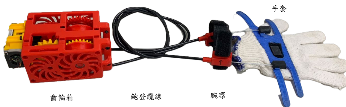
圖 3.32 穿戴式裝置的實體圖。由右至左分別是手套、腕環、鮑登纜線以及馬達與滑輪組齒輪箱
