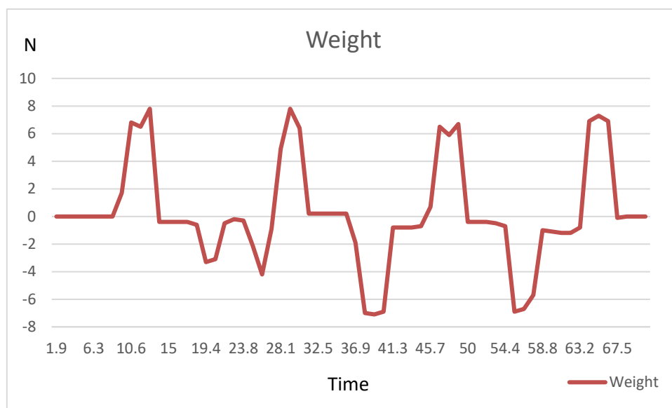
圖 3.46 推拉力計所量測的力與時間圖
