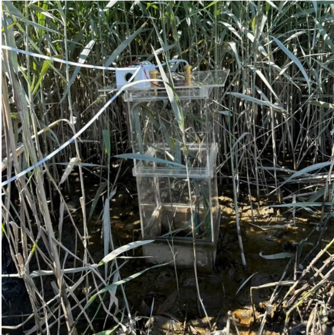
圖 19、透明氣罩進行測量時之架設
