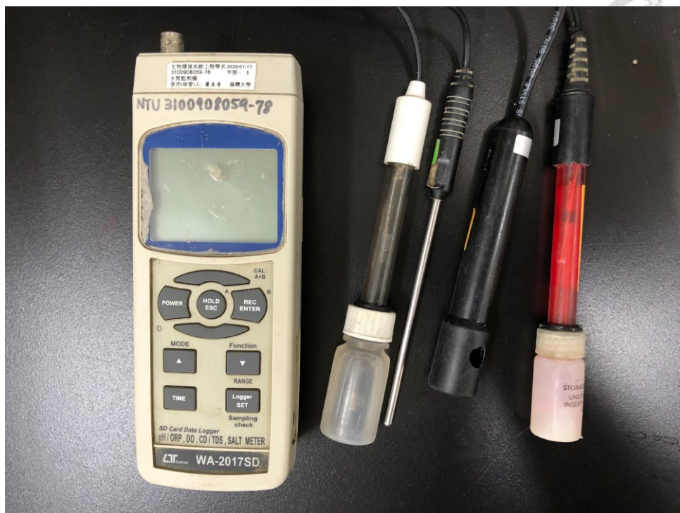
圖 12、攜帶式水質檢測儀與各參數探頭 探頭由左至右為 pH、溫度、EC、氧化還原電位計
