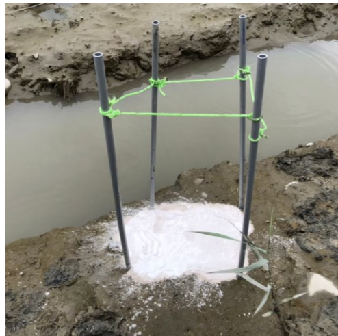
圖 28、長石粉標記法實際裝設情形
