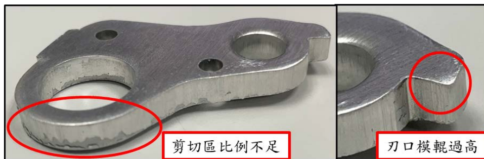
圖 1.4 目標零件缺陷(左)模輓區缺陷(右)剪切區缺陷
