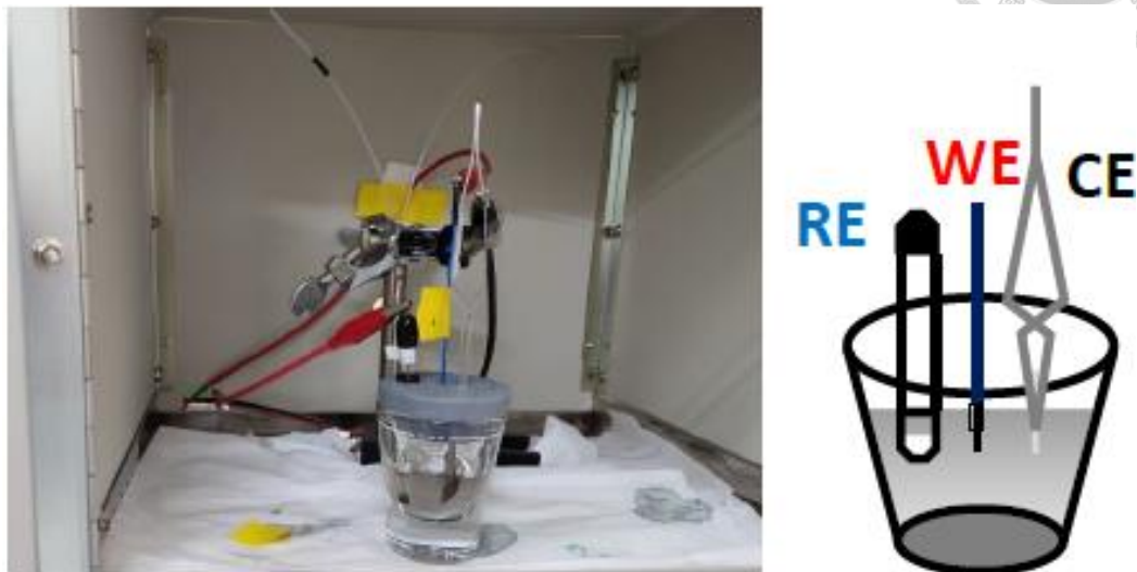
圖十四 三電極法設置圖與示意圖
