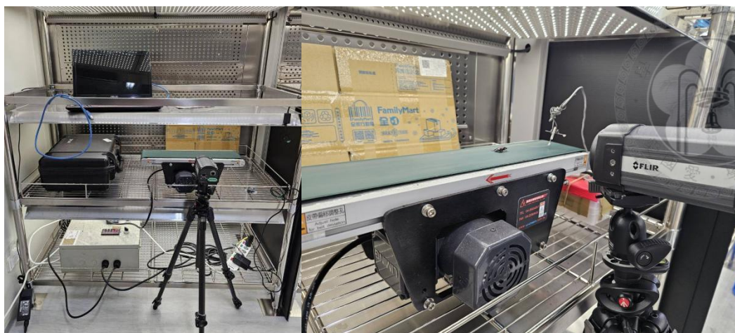
(圖 2) 運動表現測試之履帶裝置
