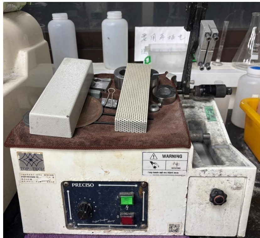
圖 3-8 慢速切割機(Top tech, CL40)
