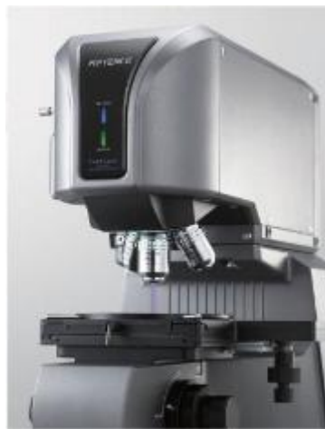
圖 3-16 雷射共軛焦顯微鏡(KEYENCE VK-9701)
