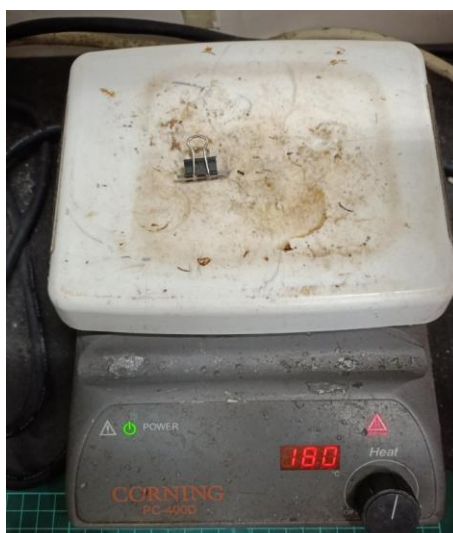
圖 3-11 以加熱盤加熱固化 AB 膠
