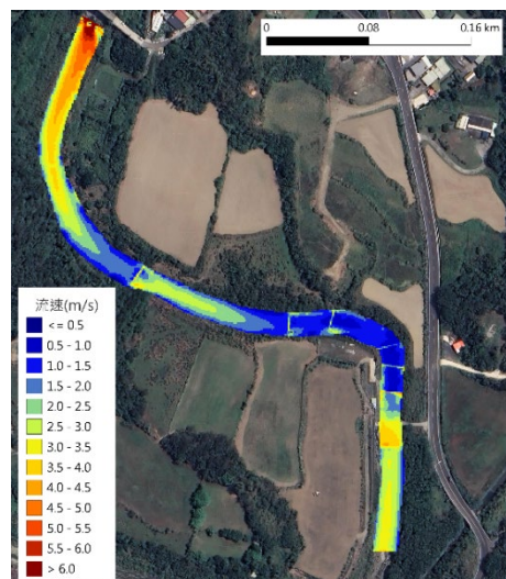
圖 4-36 泰安橋河段 Q_2 調適前後之流速(左:調適前;右:調適後)
