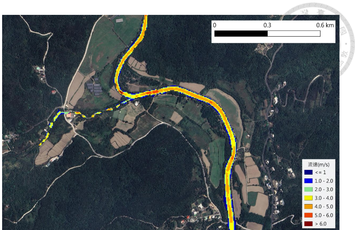
圖 4-15 港口溪及小路溪匯流處 Q_{1.11} 流速變化
