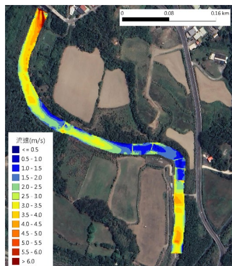
圖 4-37 泰安橋河段 Q_{50} 調適前後之流速(左:調適前;右:調適後)
