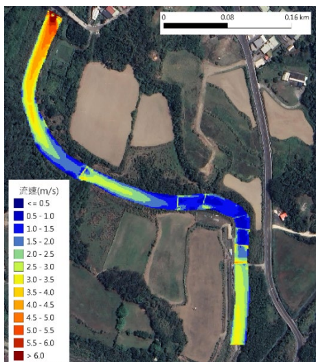
圖 4-36 泰安橋河段 Q_2 調適前後之流速(左:調適前;右:調適後)
