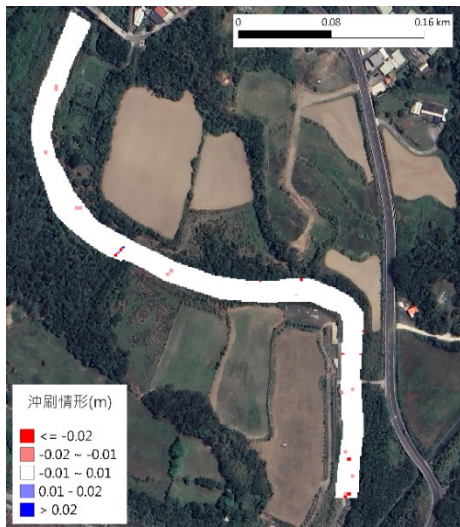
圖 4-38 泰安橋河段基流量調適前後之河床冲刷變化(左:調適前；右:調適後)
