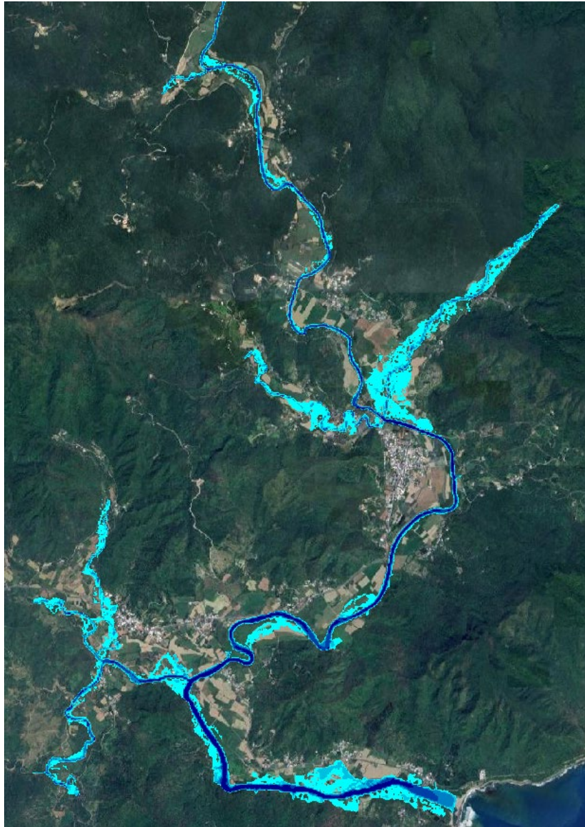
圖 4-1 Q_{50} 淹水潛勢模擬結果與衛星照片疊圖
