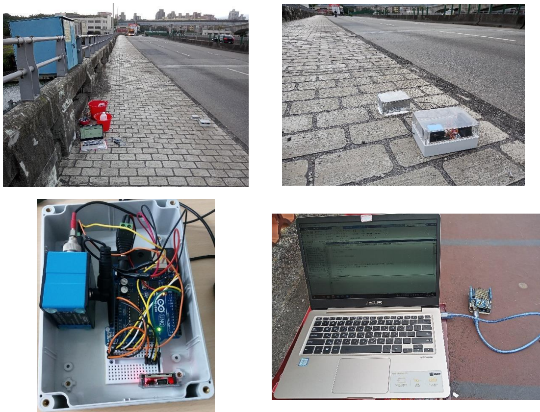
圖 4-1 無線感測儀器於橋梁上實測之配置
