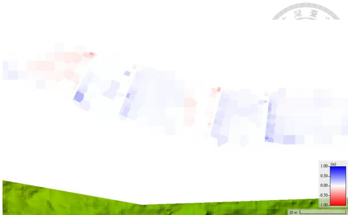
圖 4-35 Q95 第三根固床工拆除之土砂沖淤圖
