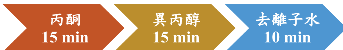
圖 4-2 基板之超音波震洗流程示意圖
