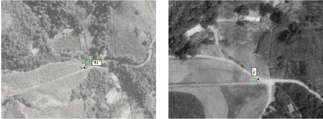
圖 4-5 在不同年間選取相同且變化不大的特徵物作為控制點。以 1956 年(左圖)1974 年(右圖)的歷史航照為例，同一區域的歷史航照在比對確認沒有改變後可使用道路交界處作為控制點的選址。
