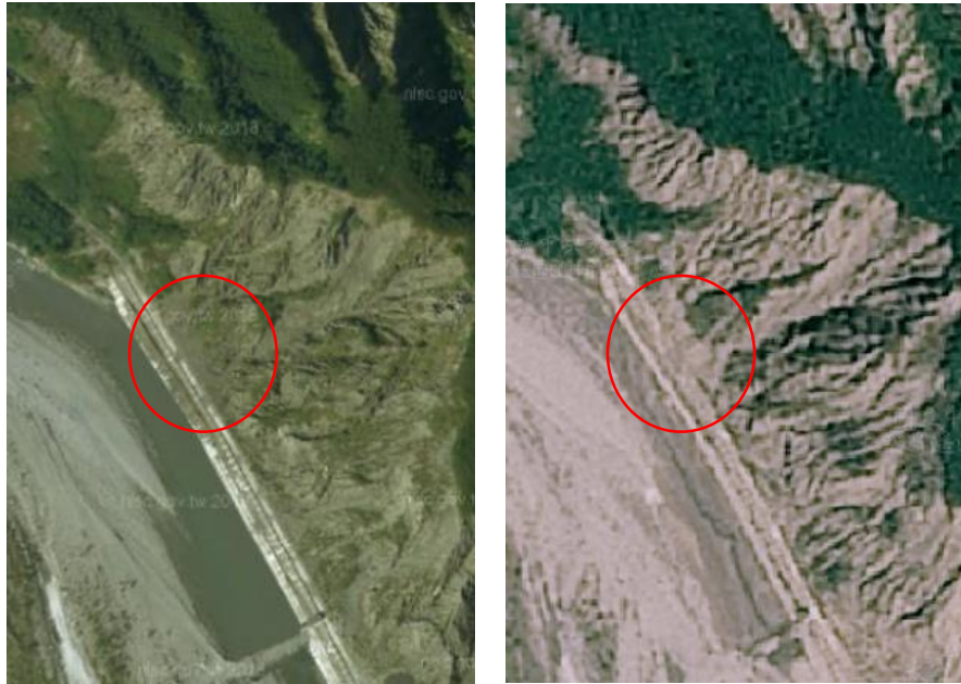
圖 6-16 2018 年(左)及 2019 年(右)利吉惡地河岸邊坡北段的衛星影像。紅圈處為利吉堤防道路被覆蓋區域。
