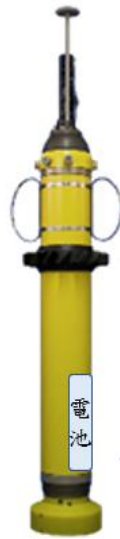
圖 2-4、EM-APEX floats 的電池配置示意圖。淺藍色矩形區域為電池模組的概略佈放位置。
