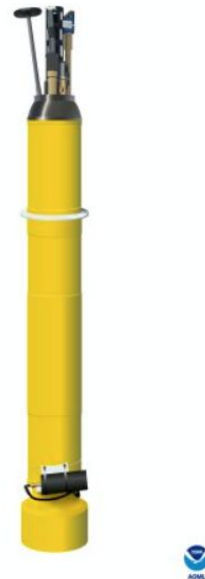
圖 1-2、(a) Datawell 海洋觀測產品—— Waverider SG 波浪浮標（圖片取自 Datawell 官方網站， https://datawell.nl/categories/buoys/ ），(b) Argo 浮標（圖片取自美國國家海洋暨大氣總署（NOAA）的大西洋海洋與氣象實驗室網站， https://www.aoml.noaa.gov/argo/ ）。
