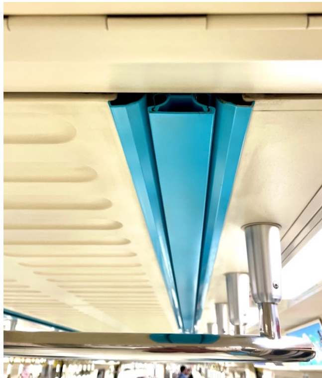
圖 11 電聯車冷氣出風口。作者攝影。
