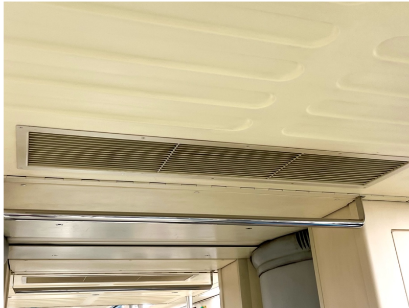
圖 12 電聯車冷氣回風口。作者攝影。
