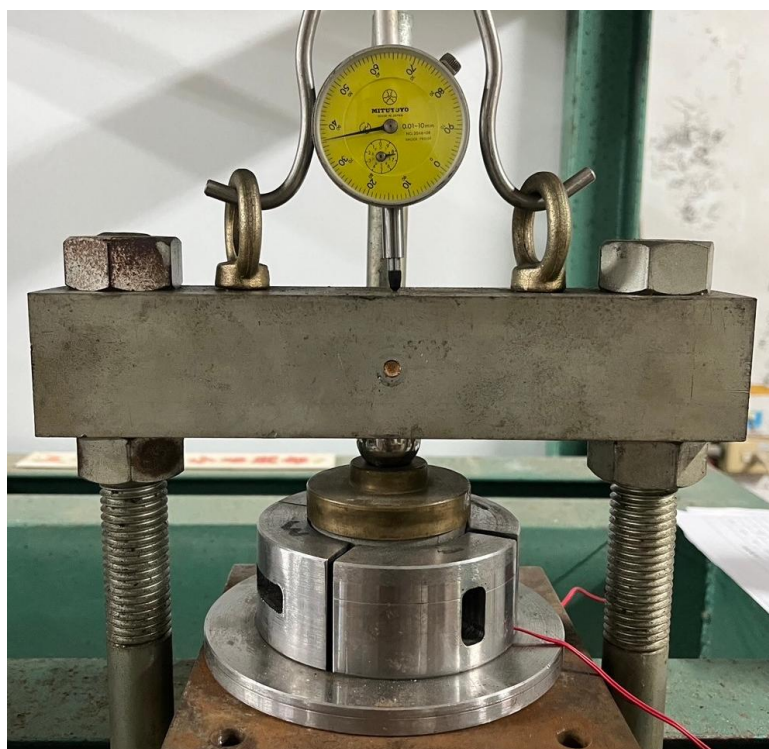
圖 3.2.13 有圍束單壓潛變試驗配置
