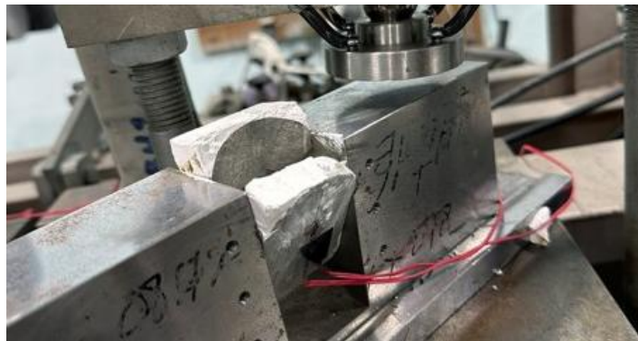
圖 3.2.17 有圍束扇形試體環壓潛變試驗破壞照片
