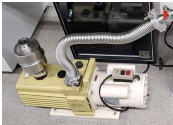
圖 4.14 真空降溫用真空幫補之架設圖，透過銀色管路連接到位於桌面的 HFS350EV-PB4 探針座。
