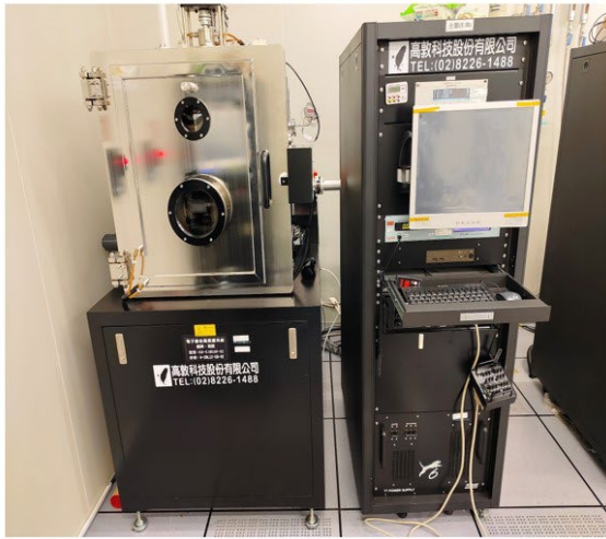
圖 2-7、(a) 電子束金屬鍍膜機外觀圖(b) 電子束金屬鍍膜機內部結構示意圖。
