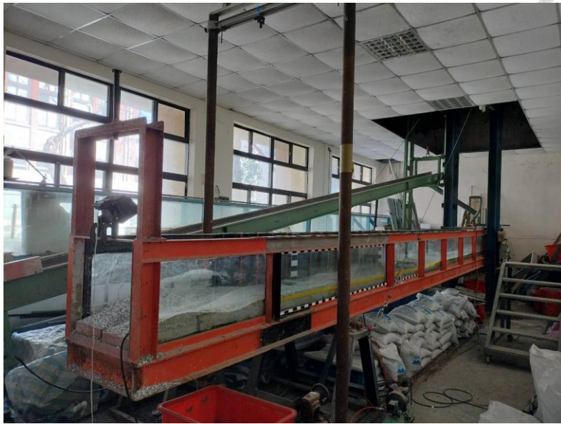
圖 4-20 實驗水槽；尺寸為長 10 公尺、寬 0.5 公尺、高 0.5 公尺。
