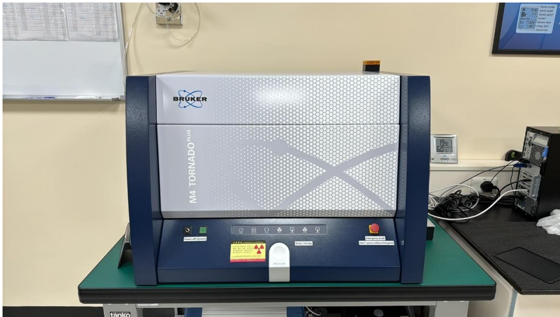
圖 2.3.4 本實驗所使用中央研究院地球科學研究所之 Bruker 公司所出產之 M4 Tornado Plus 桌上型 Micro-XRF 分析儀。圖片來源：李振維。
