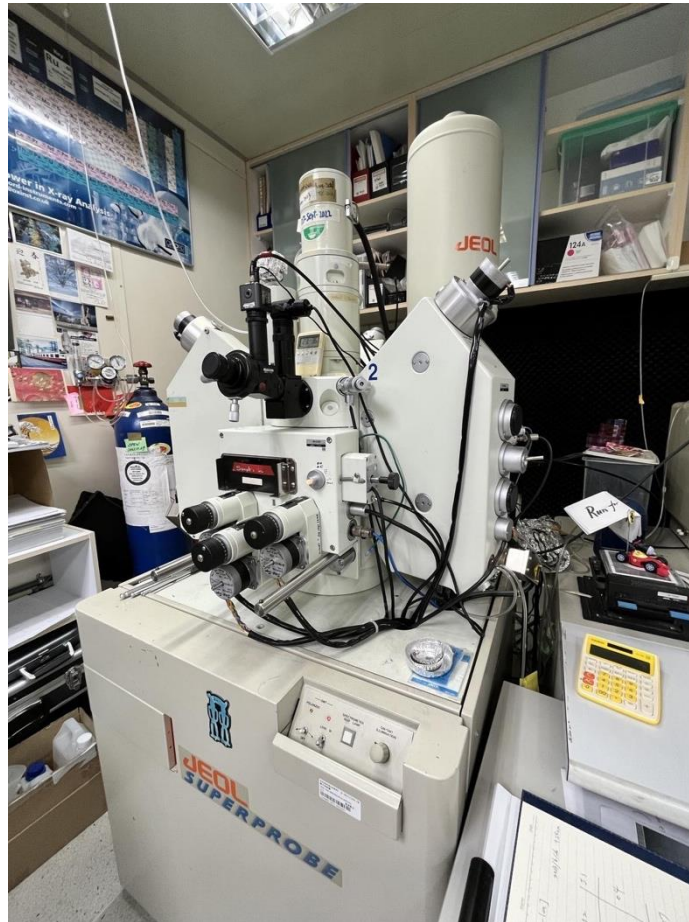
圖 2.3.5 中央研究院地球科學研究所 JEOL JXA-8900R 電子微探分析儀。
