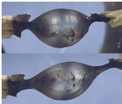
圖 4.10 在平面偏振光學系統中從側向觀測單軸向拉伸水晶體之等差線
