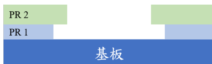
圖 3.6 於基板上塗佈之雙層光阻凹割結構
