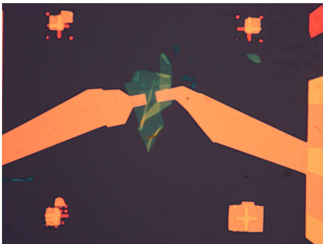
圖 A.2 雙層結構二硫化鎢電晶體，電極接觸於二硫化鎢晶體之兩端。圖中四個角落之十字長寬均為 10\ \mu\text{m} 。
