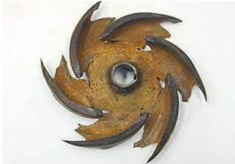
圖 2.8 經沖蝕磨損破壞的葉片[28]
