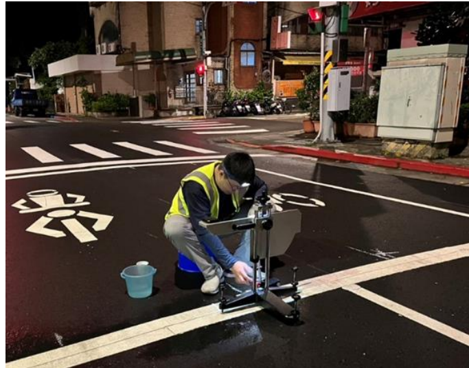
圖 3.5 CONTROLS 英式擺錘抗滑實驗儀檢測操作照片
