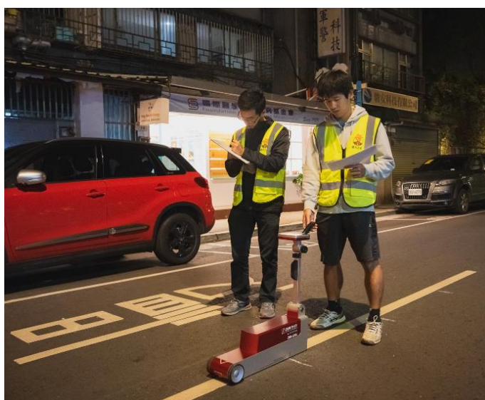
圖 3.3 ZEHNTHER ZRM 6014 反光檢測操作照片
