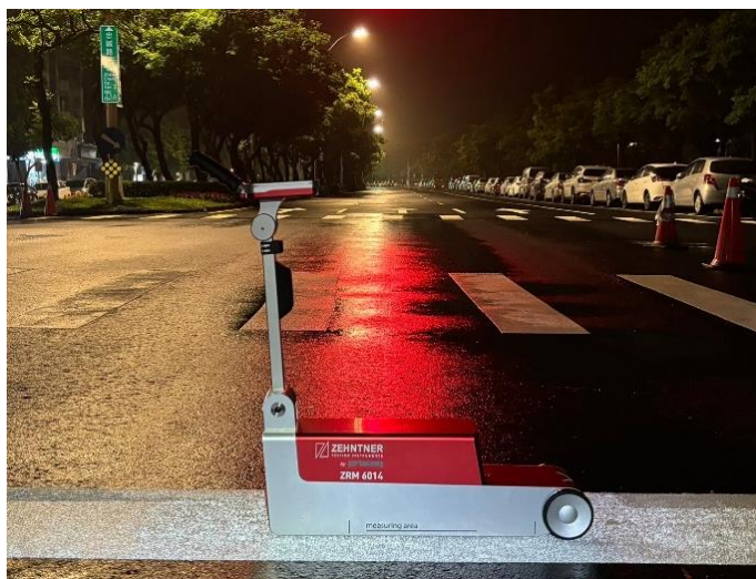
圖 3.2 ZEHNTHER ZRM 6014 反光檢測儀器照片
