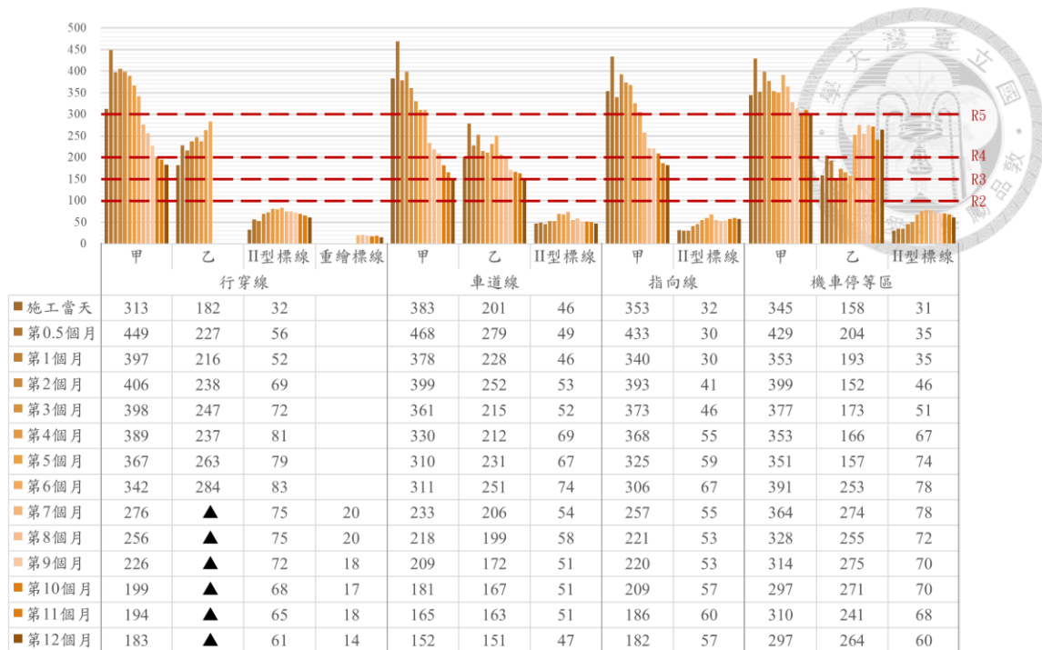
圖 4.1 甲料、乙料、II 型標線施工當天至第十二個月之 RL 性能分佈
