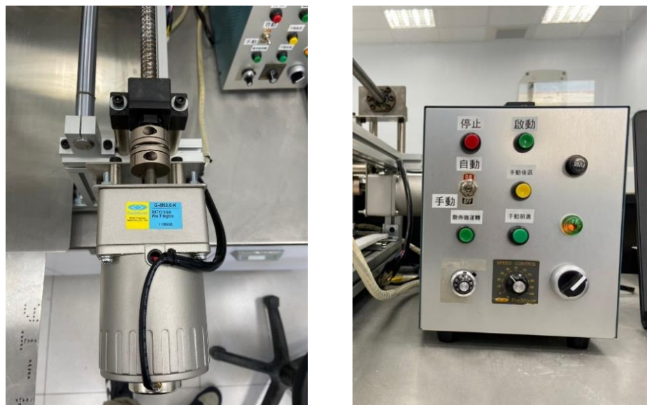
圖 3.27 減速齒輪與電動馬達(左)、可變電阻器與儀器控制器(右)
