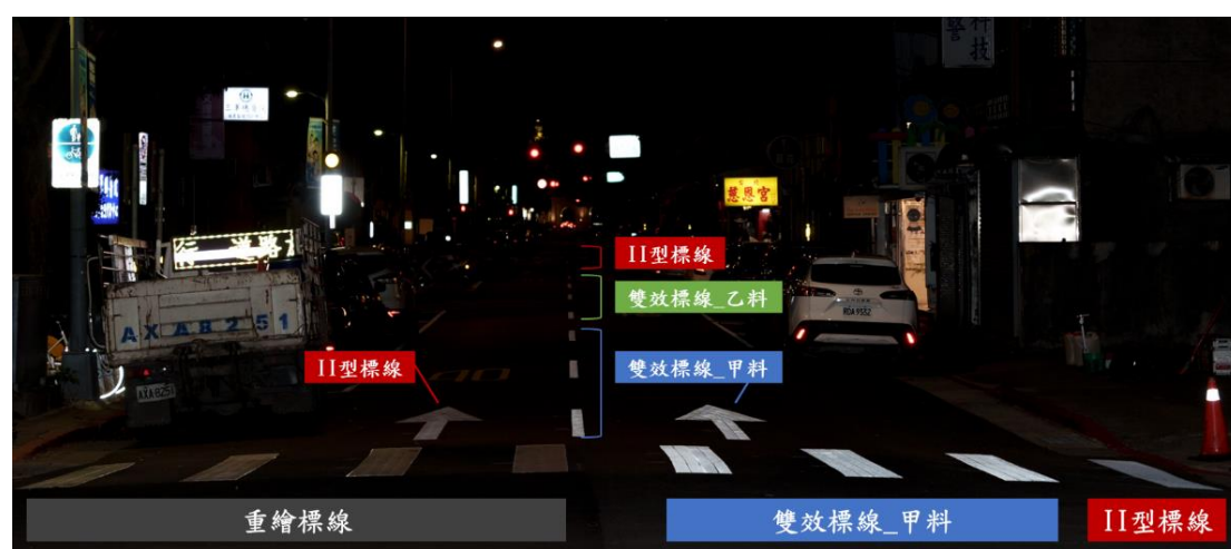
圖 4.5 紹興南街各標線材料之反光性能比較
