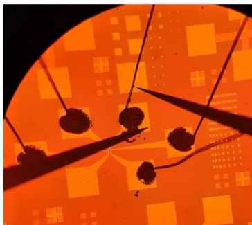
圖 5-3-2 使用金線及銀膠連接樣品與量測系統
