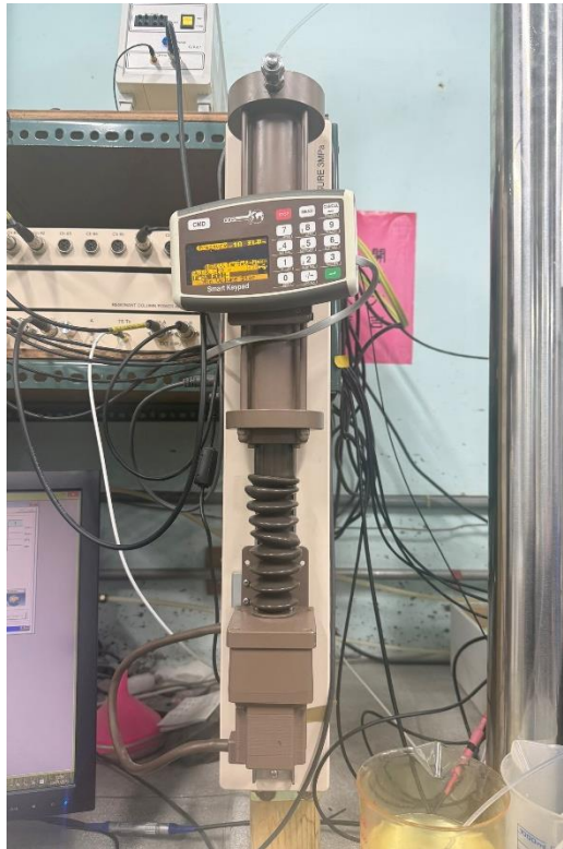
圖 3-19 壓力體積控制系統
