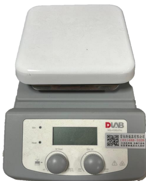
圖 2-5 磁石加熱攪拌器
