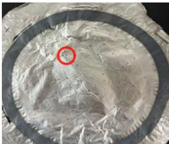
圖 2-55 極化架設 1-擊穿現象
