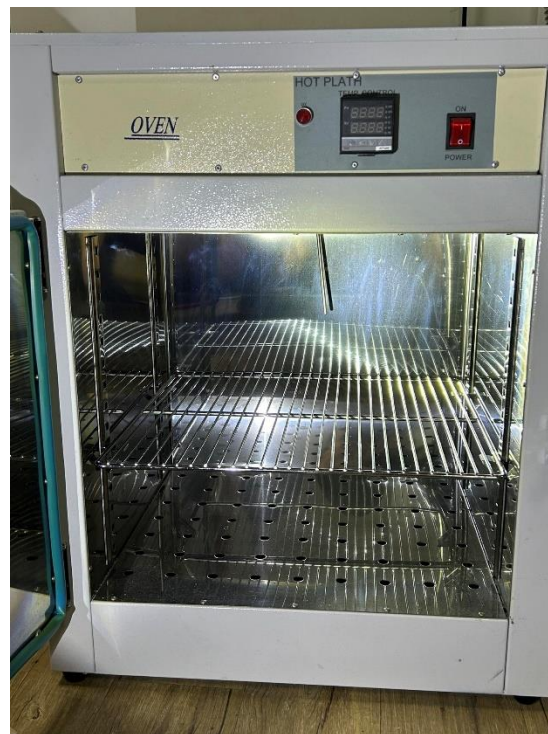
圖 2-9 電汽烘箱內部
