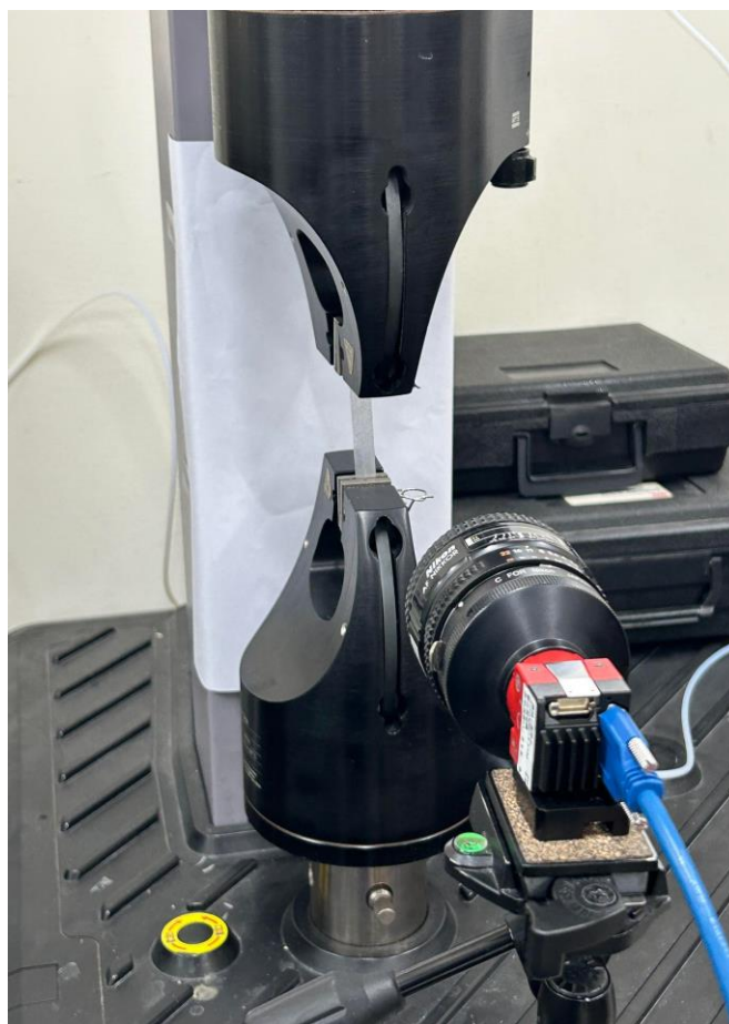
圖 2-84 拉伸試片夾持與相機架設圖
