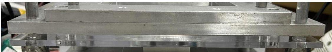
圖 2-97 上、下蓋組合和附載重物四層結構
