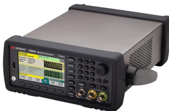
圖 3-5 Keysight 33621A 訊號產生器
