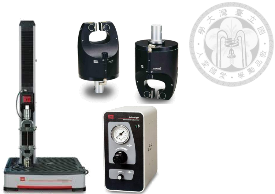
圖 2-82 拉伸試驗機組件
