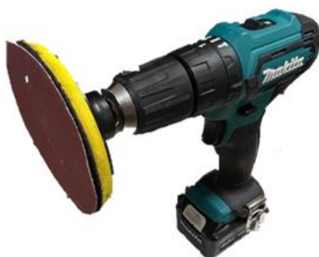
圖 2-26 砂紙+電鑽拋光器
