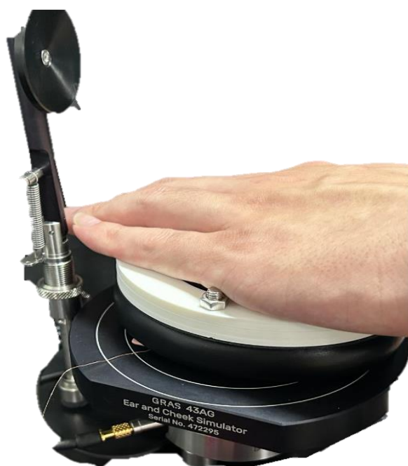
圖 6-28 人工耳量測(手掌輕壓)
