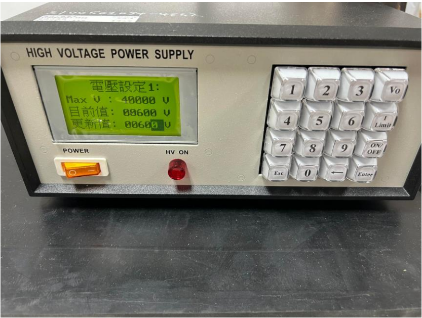
圖 2-49 高壓直流電源供應器儀器圖
