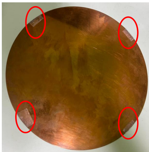
圖 2-41 銅基材四角落貼膠帶
