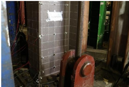
(c) 正 0.03 rad 第一圈柱底腹板挫屈
