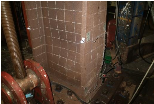
(c) 試驗結束柱底南側局部挫屈
