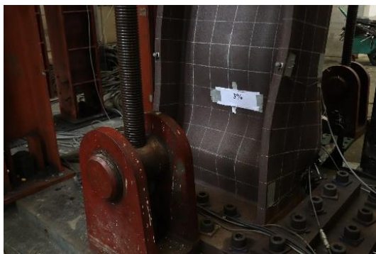
(d) 柱底嚴重挫屈故試驗中止
