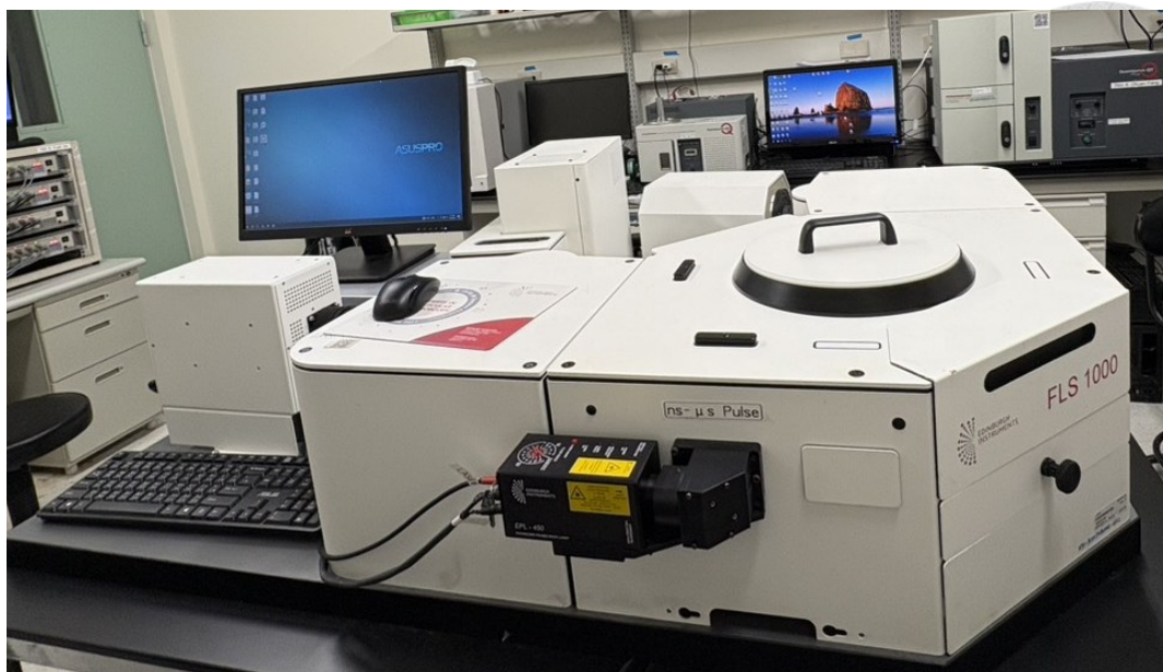
圖 2-21 FLS1000 光致發光光譜儀。
