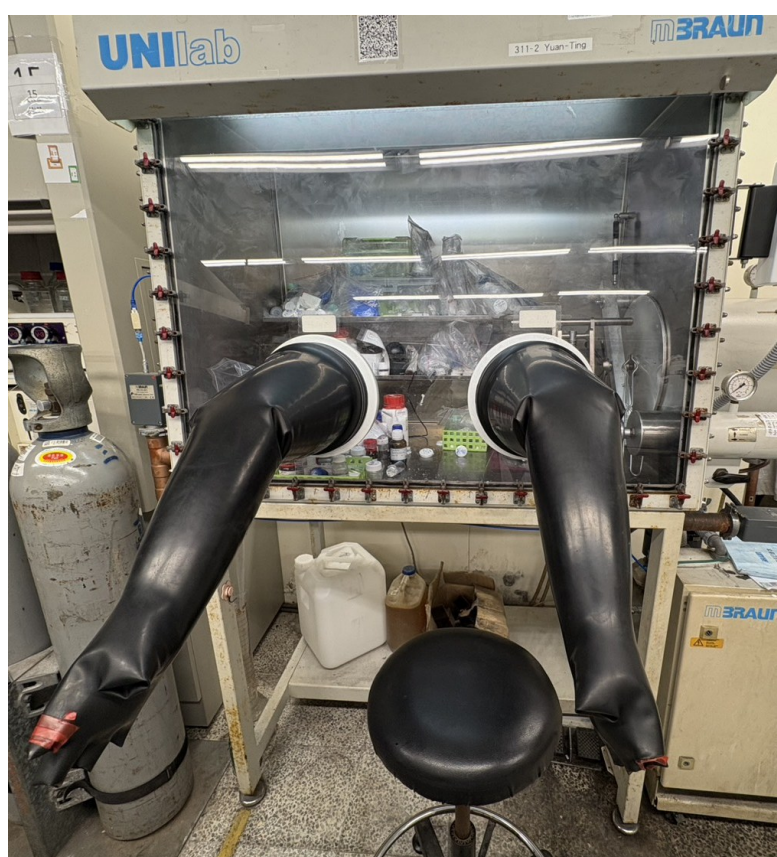
圖 2-4 MBRAUN UNIlab 手套箱。
