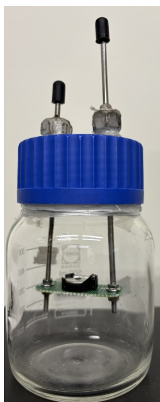
圖 2-6 充放電測試用之血清瓶。
