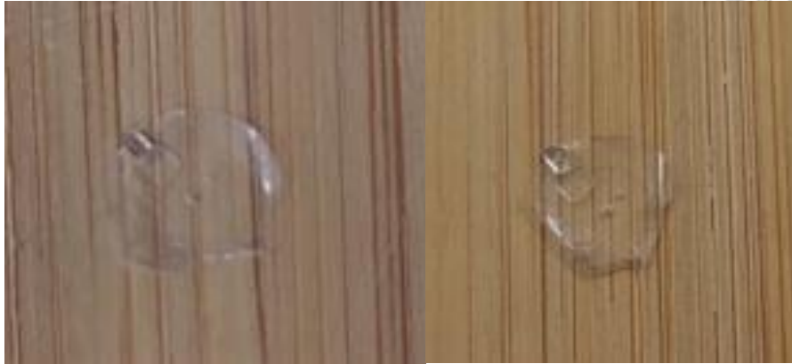
圖4.2 熱固化成品 70°C(左) 85°C(右)
