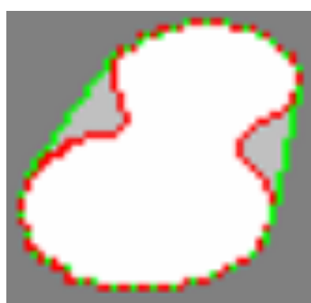
圖 4.3-1 Image pro Plus 6.0 之 Perimeter(ratio)定義示意圖
