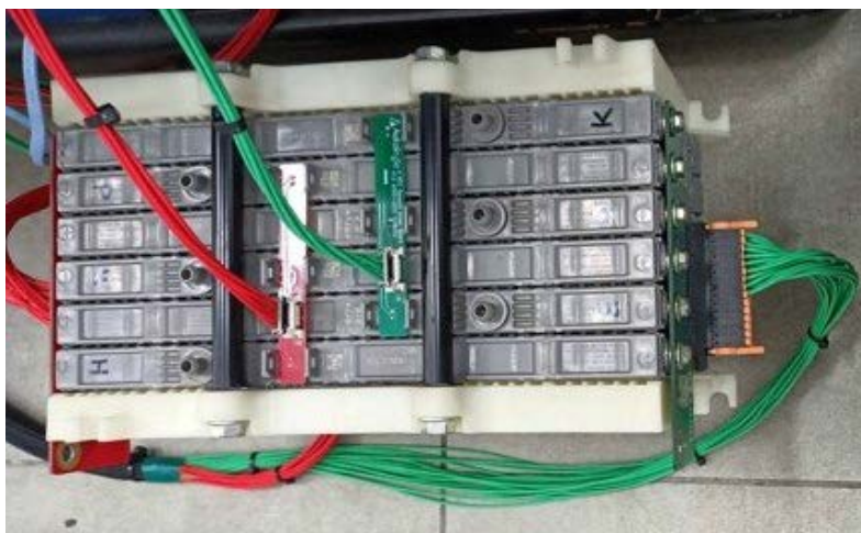
圖 3-5 高溫老化實驗電池組 (內含 6 個模組)
